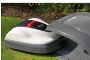
Lading i ladestasjonen
